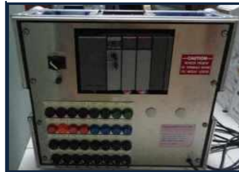
Allen Bradley SLC 5/03
