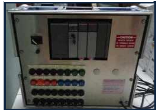
Allen Bradley SLC 5/03
