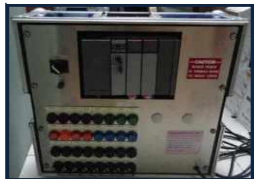
Allen Bradley SLC 5/03
